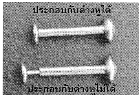
รูปภาพที่ 3 ปัญหาผลิตภัณฑ์รุ่น Tita 0.5×1.2×08×4 ความลึกของรูต่างหูไม่เป็นไปตามข้อกำหนด (ที่มา: ผู้วิจัย)
